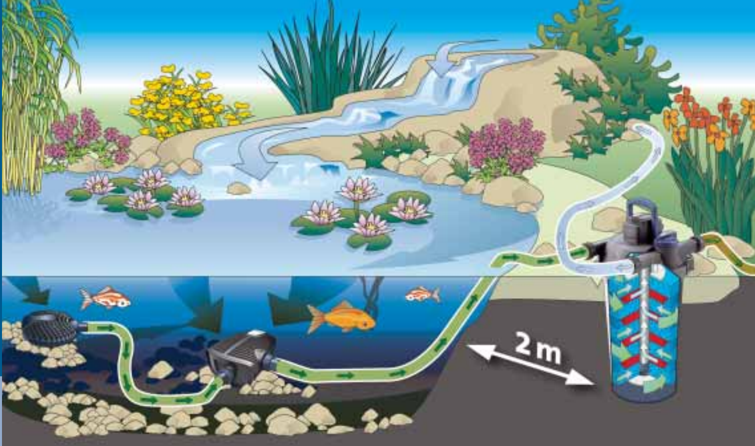
Schematic diagram: Filter and watercourse pump AquaMax Eco Premium (PRO) in Kombination mit einem OASE-Druckfilter FiltroClear (PRO)
